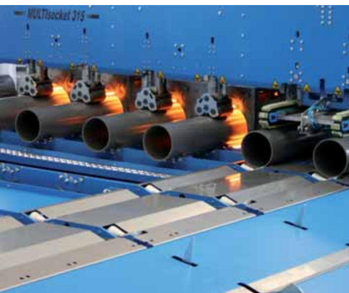
A gama de bolsadeiras Multisocket está equipada com fornos de ondas curtas
