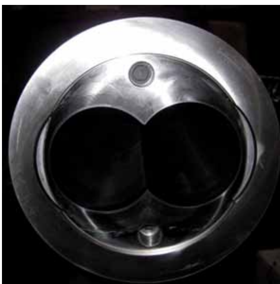
Um cilindro bimetálico desenvolvido para melhorar as potencialidades das extrusoras de dupla rosca
